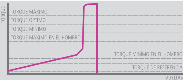
EXCESO DE TORQUE Y DEFORMACIÓN PLÁSTICA
